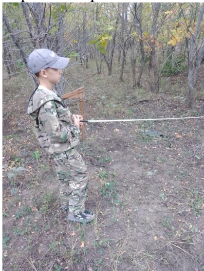
Фото 8. Определение размеров пробной площади при помощи мерной ленты
