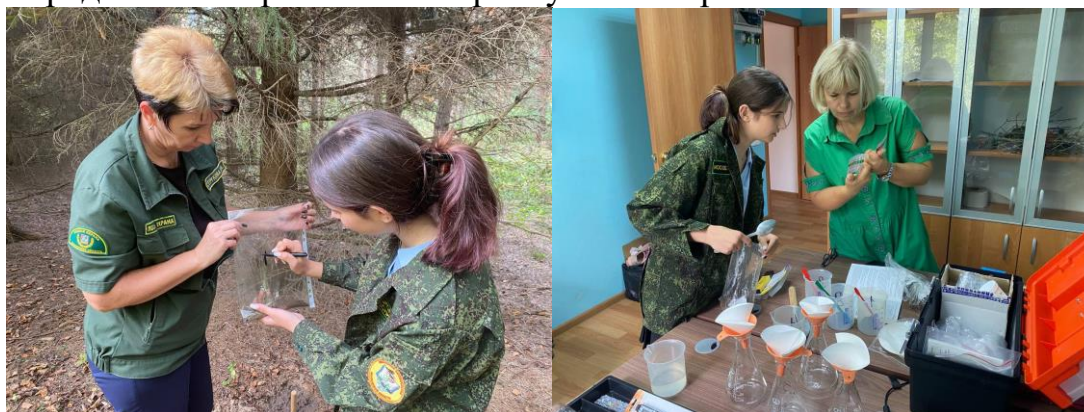
Рис. 12-13 Отбор почвенных образцов и определение кислотности почвы с помощью РН-метра
