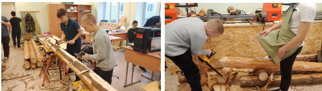
Рис.12 . Подготовка столбов для знаков: ошкуривание и заострение
