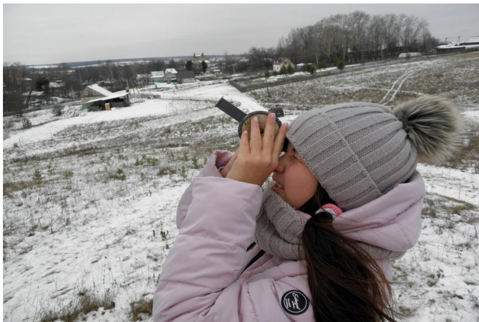
Рис. 2 Определение высоты дерева с помощью эклиметра. Фото Кондратьева А.А.
