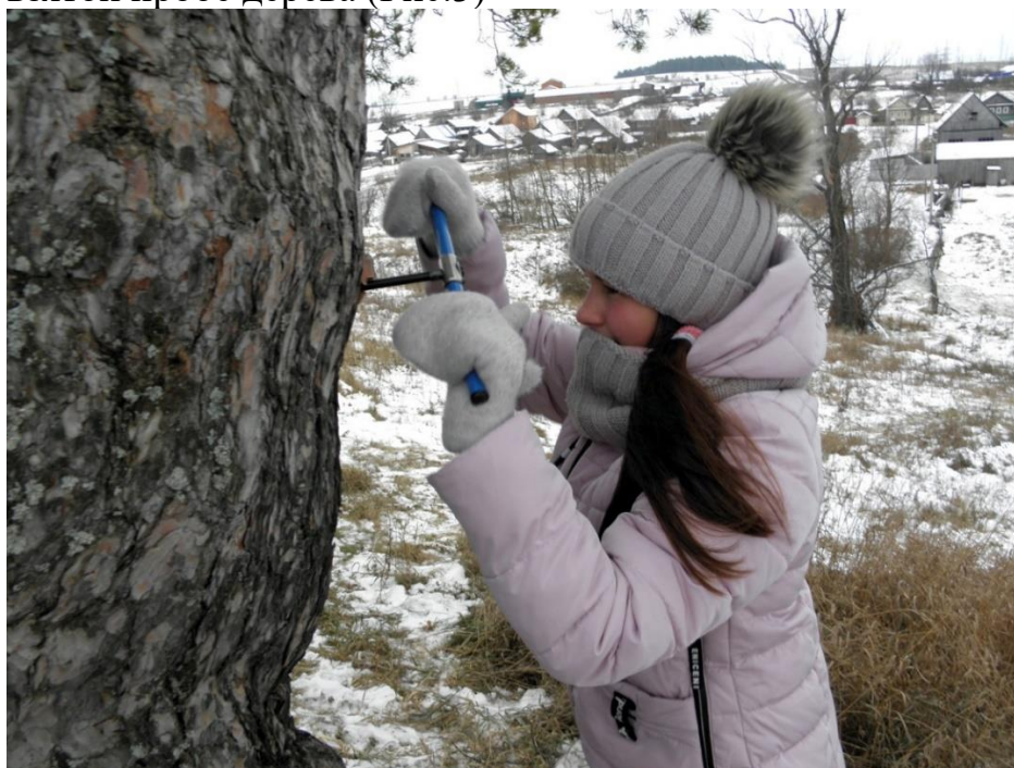
Рис. 3 Определение возраста дерева с помощью возрастного бура.
