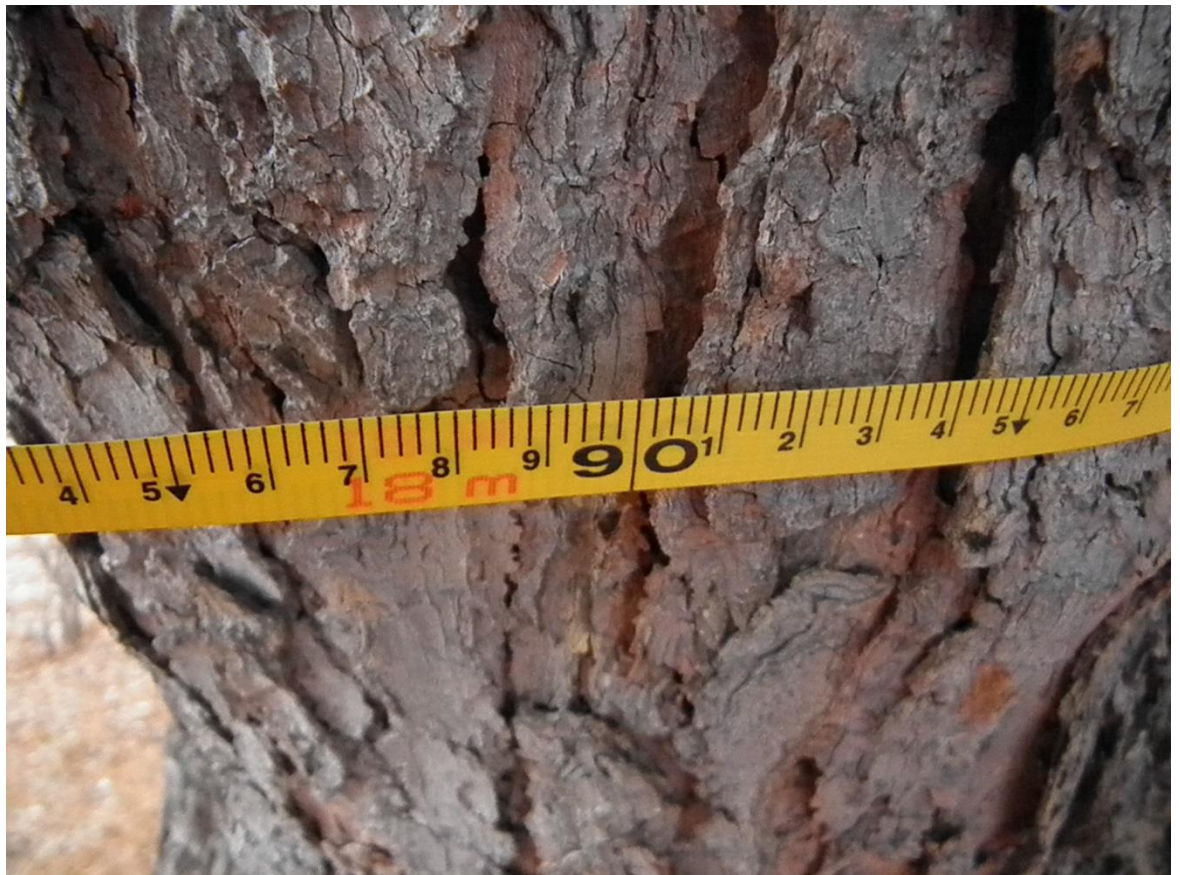
Рис.1 Измерение обхвата дерева с помощью рулетки. Фото Кондратьева А.А.
