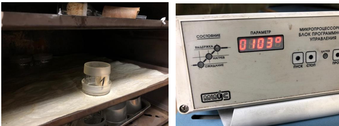
Рис. 6.2 – Сушильный шкаф с терморегулятором
