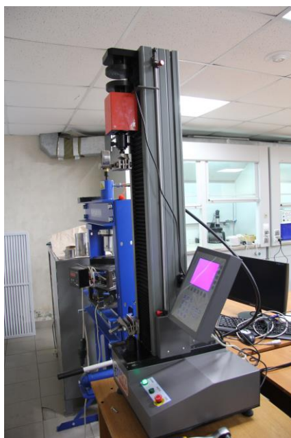
Рис. 5.5 – Испытательная машина для измерения предела прочности деревянного образца с постоянной скоростью нагружения
