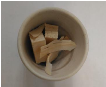
Рис. 7.2 – Тигли с навесками древесины и коры
