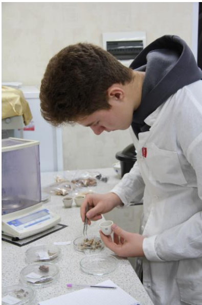
Рис. 7.1 – Отбор и взвешивание проб древесины и коры.
