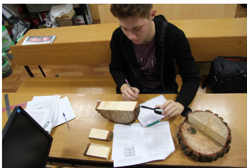
Рис. 4.2 – Определение макроскопических параметров древесины
