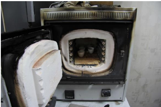
Рис. 7.3 – Муфельная печь с исследуемыми образцами
