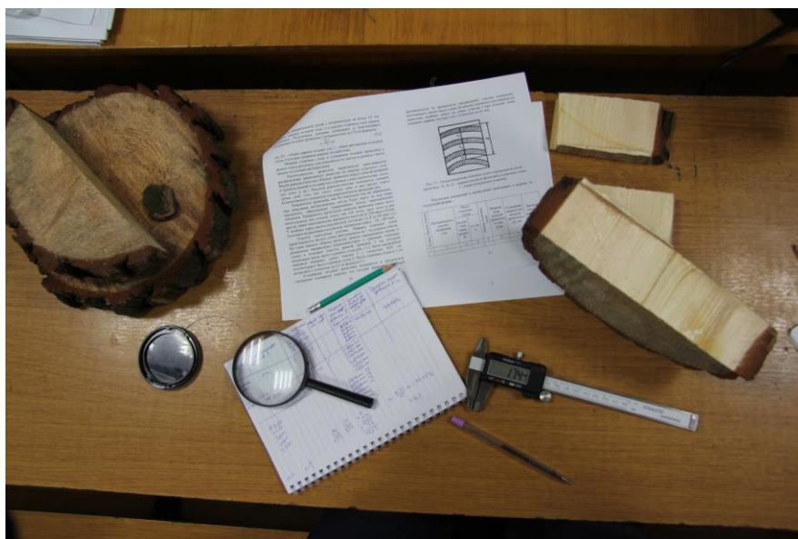
Рис. 4.1 – Подготовка к определению макроскопических параметров древесины
