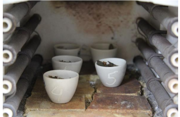
Рис. 7.3 – Муфельная печь с исследуемыми образцами
