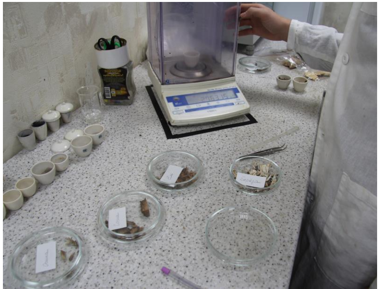
Рис. 7.1 – Отбор и взвешивание проб древесины и коры.
